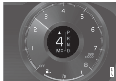
Käiguvahetuse näidik 12-tollisel juhiekraanil suure käigukangi korral*.
