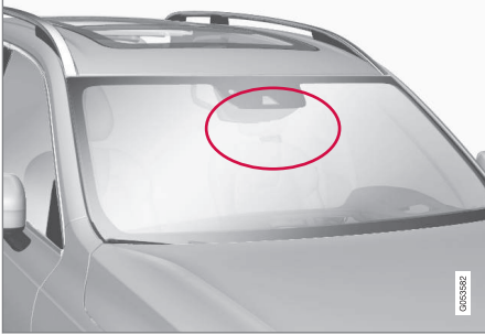
Radar ünitesi konumu
