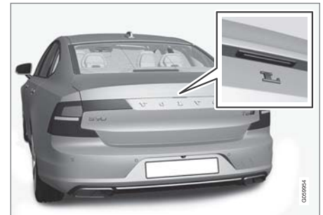
แผ่นกดยางบนฝากรองหลังใช้สำหรับการปลดล๊อคเท่านั้น
