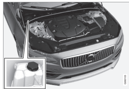
Expansionskär för kylsystem, vänsterstyrd bil
