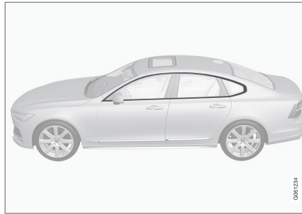
Detaljer som bör tvättas med rengöringsmedel med pH-värde mellan 3,5 till 11,5.
