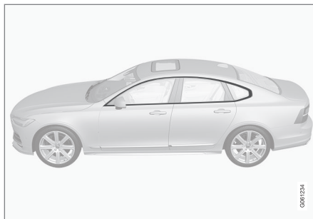
Diely, ktoré by sa mali umývať čistiacim prostriedkom s hodnotou pH medzi 3,5 a 11,5.
