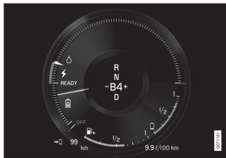
Displej vodiča indikuje nabíjanie počas brzdienia elektromotorom.
