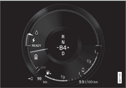
O visor do motorista indica carregamento na frenagem com o motor elétrico.
