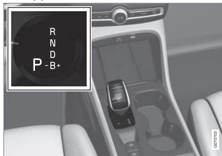
Prezentacja dźwigni zmiany biegów i układu biegów na wyświetlaczu kierowcy.
