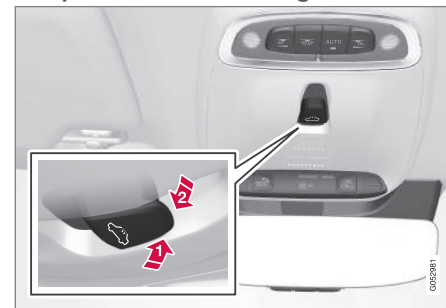
Uchylenie i zamykanie okna dachowego.
