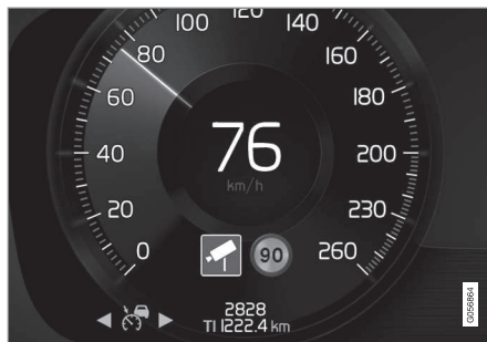
Przykładowe informacje o fotoradarze i limicie prędkości na wyświetlaczu kierowcy
