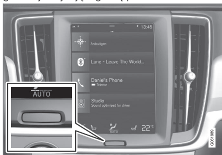
Przycisk strony głównej wyświetlacza centralnego.
