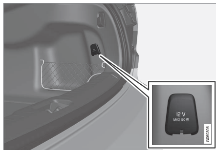
Gniazdo elektryczne 12 V w przestrzeni bagażowej*.
