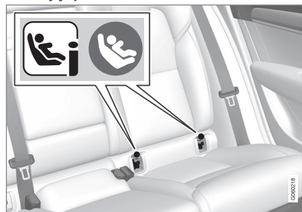
Rozmieszczenie zaczepów mocujących w tylnych siedzeniach.
