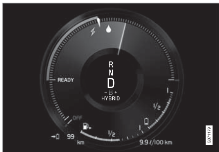
운전자 화면에 전기 모터와 내연기관 모두를 이용한 추진력이 표시됩니다.
