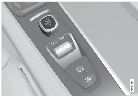
Interruttore di avviamento nel tunnel.
