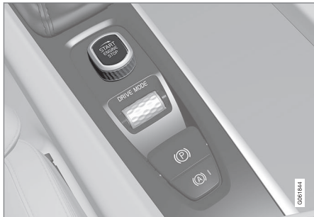
Interruttore di avviamento nel tunnel.
