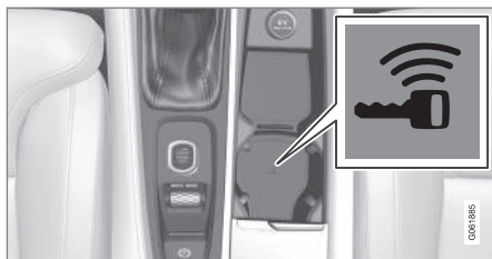
Varmistuselukijan sijainti mukinpitimessä.
