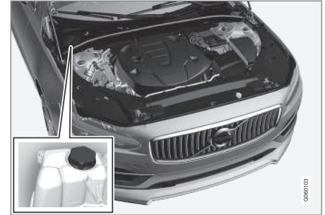
Jäähdytysjärjestelmän paisuntasäiliö, vasemmalta ohjattava auto
