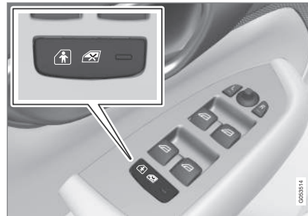
Botón de conexión y desconexión eléctrica.
