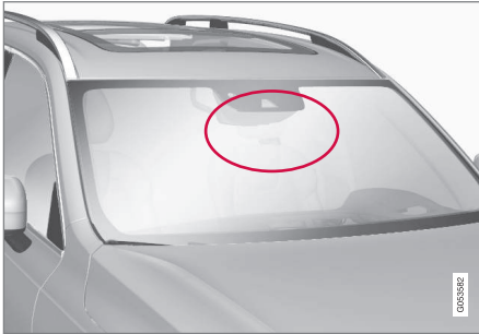
Ubicación de la unidad de cámara
