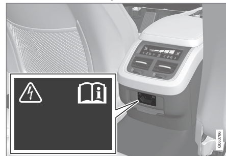
Toma eléctrica en consola del túnel, asiento trasero.
