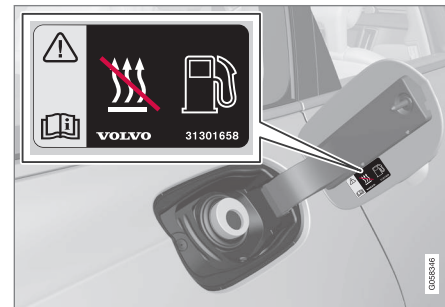
Letrero en la parte interior de la tapa del depósito.
