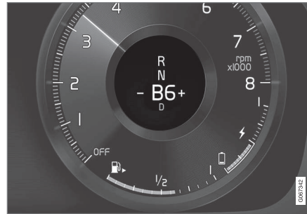
Schaltanzeige im Fahrerdisplay 5 .
