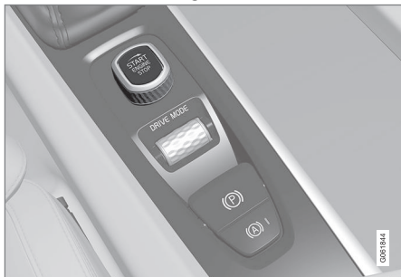
Startschalter auf der Tunnelkonsole.
