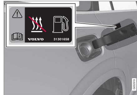
Warnaufkleber auf der Kraftstofftankklappe.
