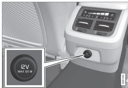
12V elektrická zásuvka v tunelové konzole, zadní sedadlo.
