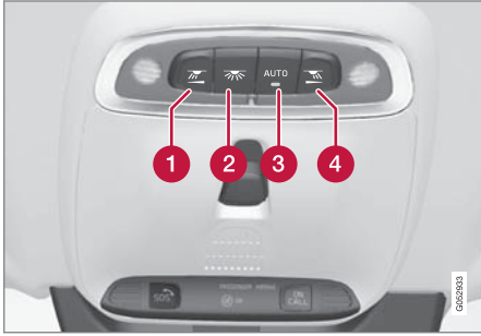
مفاتيح التحكم في كونسول السقف لمصابيح القراءة الأمامية وإضاءة مقصورة الركاب.
