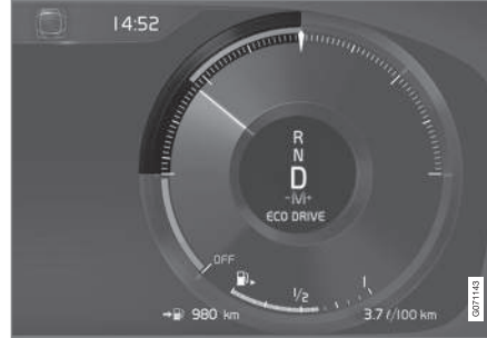
12 inç sürücü ekranındaki Eco göstergesi*.
