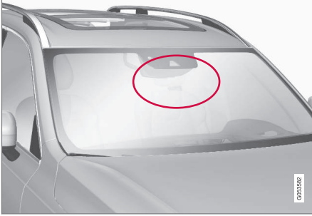
Radar ünitesi konumu
