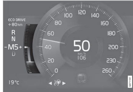
8 inç sürücü gösterge ekranındaki Eco göstergesi.
