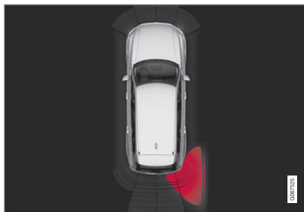
ไอคอนที่ติดสว่างขึ้นสำหรับ Cross Traffic Alert ในภาพกราฟิก Park Assist System บนหน้าจอ
