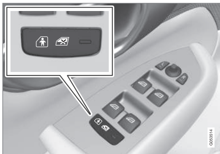
Knapp för elektrisk aktivering och deaktivering.
