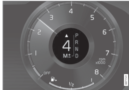
Växlingsindikator i 12-tums förardisplay för stor växelspak*.
