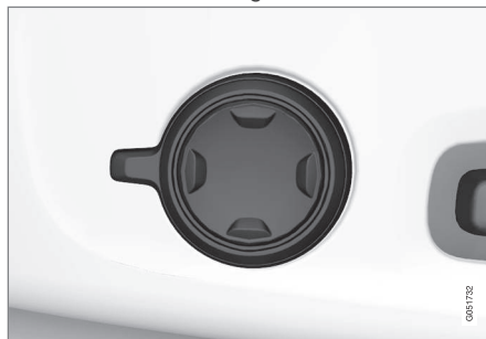
Multifunktionsreglaget, placerad på sidan av sätets sittdel.
