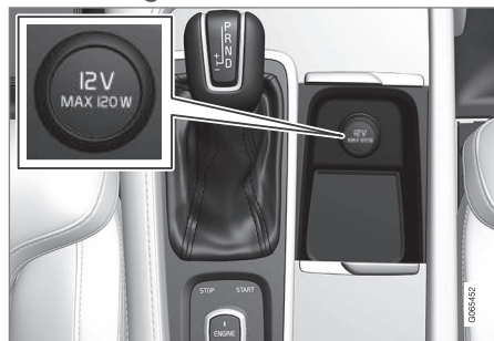
12 V-eluttag i tunnelkonsol, framsäte.
