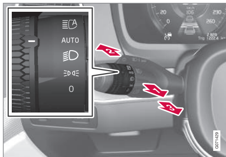
Rattspak med vridning.
