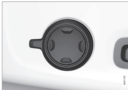
Multifunktionsreglaget, i bilar med fyrvägssvankstöd*.
