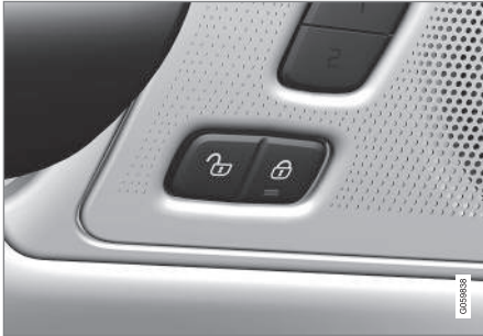
Knapp för låsning och upplåsning i framdörr med indikeringslampa.
