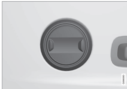
Reglaget i bilar med tvåvägssvankstöd*.
