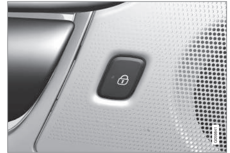
Knapp för låsning i bakdörr med indikeringslampa.
