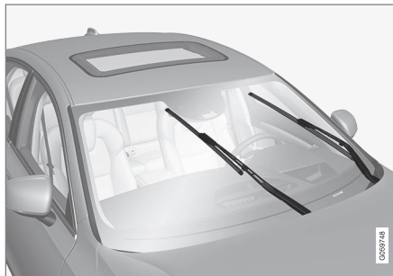
Torkarblad i serviceläge.
