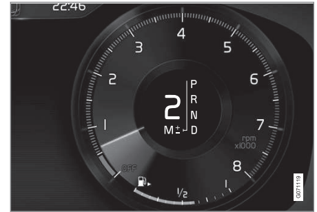
Förardisplay vid växling med rattpaddlar i manuellt växelläge stor växelspak.
