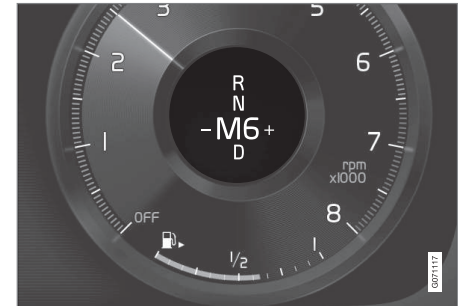
Prehľad vzoru radenia na displeji vodiča pre malú radiaciu páku.
