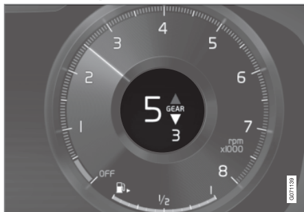
Indikátor prevodových stupňov na 12-palcovom displeji vodiča*.
