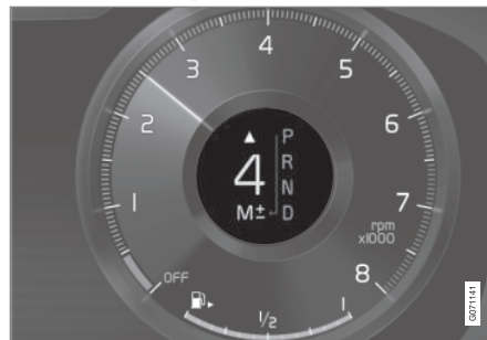
Indikátor prevodových stupňov na 12-palcovom displeji vodiča pre veľkú radiacu páku*.
