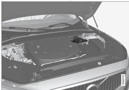
12 V podporná batéria sa nachádza v krabici vedľa veže vzpery.
