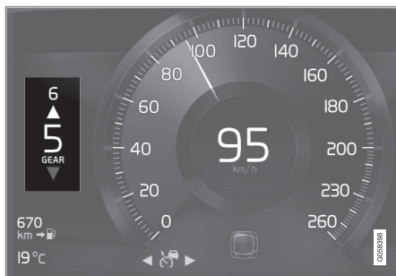
Indikátor prevodových stupňov na 8-palcovom displeji vodiča.
