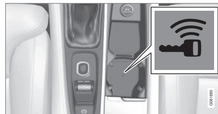
Umiestnenie záložnej čítačky v konzole tunela.
