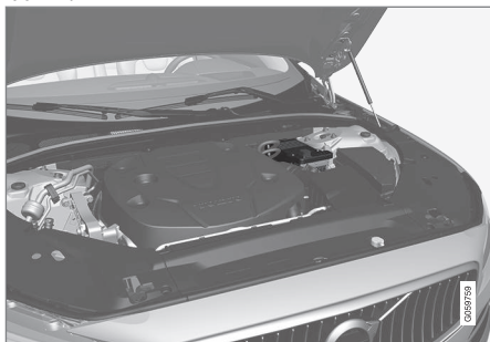
Вспомогательный аккумулятор 12 В находится в ящике рядом с пружинной стойкой.
