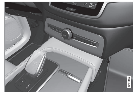
Компактный рычаг переключения передач без отключения блокиратора переключения передач.
