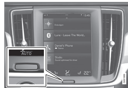
Кнопка Начало центрального дисплея.
