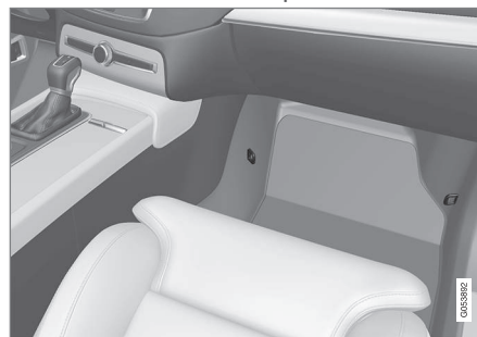
Расположение точек крепления для переднего сиденья.
