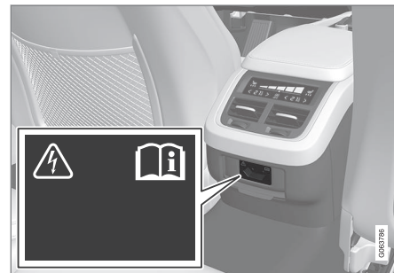
Электрическое гнездо в тоннельной консоли, заднее сиденье.
