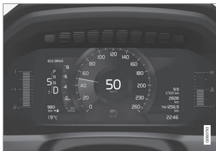
8-дюймовый дисплей водителя.
