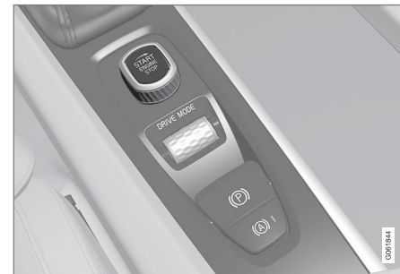
Ручка запуска в тоннельной консоли.
