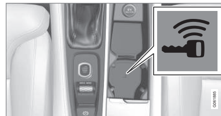
Расположение резервного считывающего устройства в тоннельной консоли.
