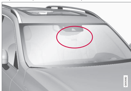
Расположение блока камеры
