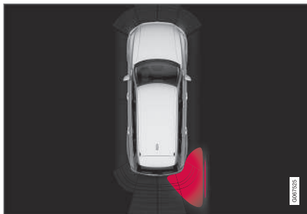
Светящийся значок Cross Traffic Alert на графике Система парковки.
