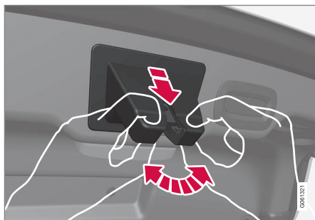
Резиновая оболочка замка крышки багажника.
