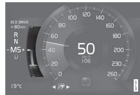
Указатель ECO на 8-дюймовом дисплее водителя.
