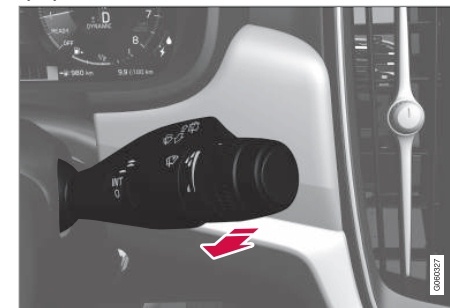
Функция омывания, правый подрулевой рычаг.
