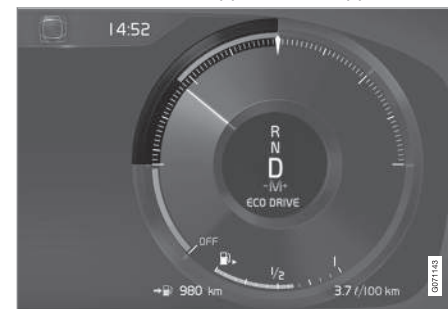
Указатель ECO на 12-дюймовом дисплее водителя*.
