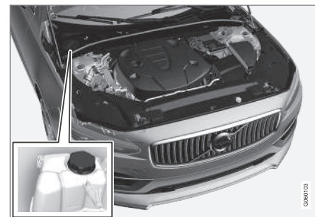
Vas de expansiune pentru lichidul de răcire, mașină cu volan pe stânga
