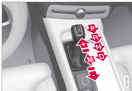
Overzicht grote schakelhendel en schakelstanden.
