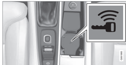
Positie back-uplezer in de tunnelconsole.
