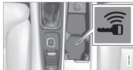
Posizione del lettore di riserva nella consolle del tunnel.
