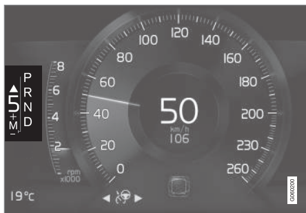
Indicatore cambio di marcia sul display del conducente da 8" per la leva selettore grande.
