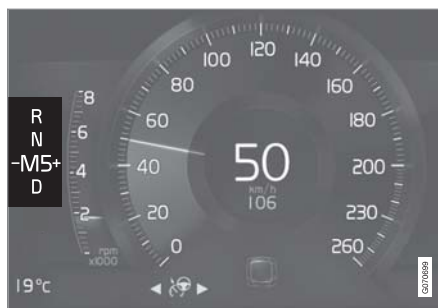
מחוון החלפת ההילוכים בצג נהג 8 אינץ' עבור ידית בורר הילוכים קטנה*.
