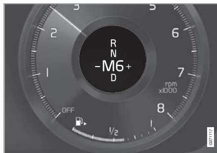
מחוון החלפת ההילוכים בצג נהג 12 אינץ' עבור ידית בורר הילוכים קטנה*.
