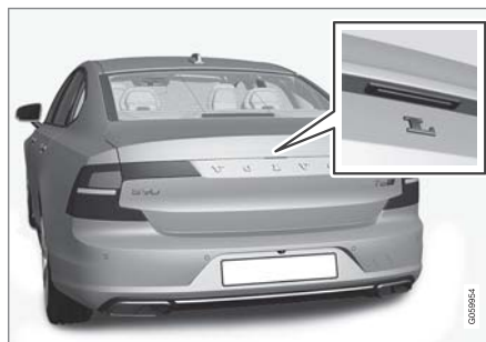
לוח הלחץ המצופה בגומי שעל מכסה תא המטען יכול לשמש רק לשחרור נעילה.
