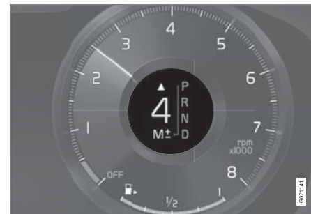
מחוון החלפת ההילוכים בצג נהג 12 אינץ' עבור ידית בורר הילוכים גדולה*.
