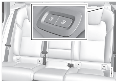
Bouton de basculement des sièges, placé sur la partie supérieure de la banquette à gauche.
