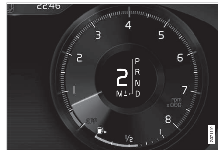
Vue d'ensemble de la grille de positions sur l'écran conducteur, pour un gros levier de vitesses.
