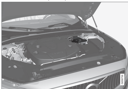
12 V:n apuakku sijaitsee laatikossa joustintukitornin vieressä.
