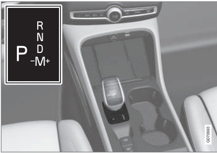
Yleiskuva pienestä vaihdevivusta ja vaihtokaaviosta kuljettajan näytössä.
