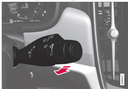
Función de lavado, palanca derecha del volante.
