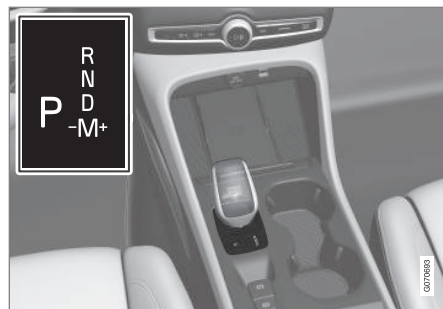
Oversigt over lille gearstang og gearskiftemønster på førerdisplay.
