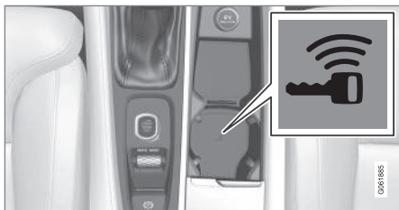
Backup-læserens placering i tunnelkonsollen.
