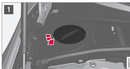
Ekspansionsbeholder for kølesystemet, venstrestyret bil
