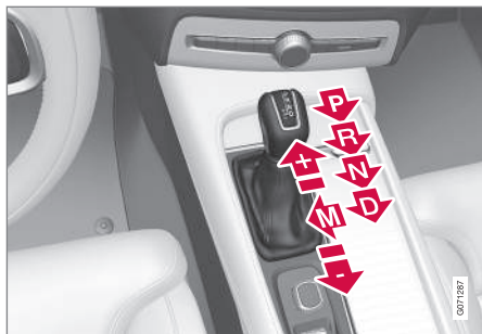
Oversigt over stor gearstang og gearpositioner.
