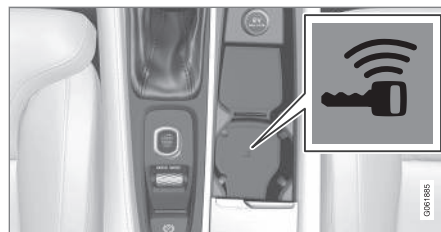
Backup-læserens placering i tunnelkonsollen.
