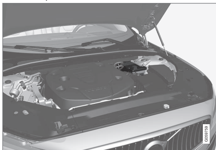
Støttebatteriet på 12 V er placeret i en kasse ved siden af fjederbenstærket.
