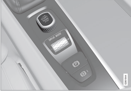
Tünel konsolundaki çalışma düğmesi.
