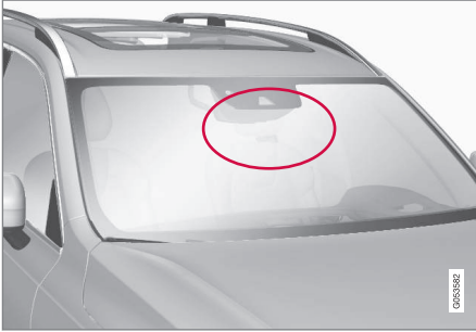
Radar ünitesi konumu
