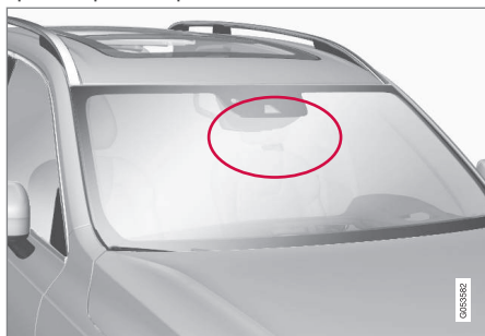
Положение радиолокационного блока
