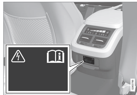
Priza electrică din consola tunel, scaunul spate.
