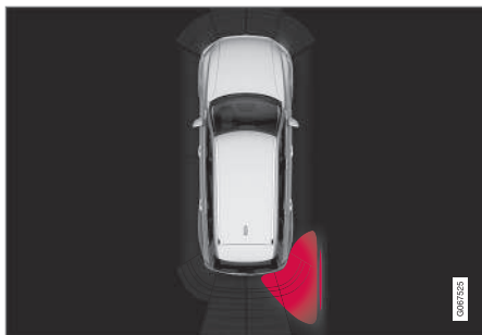
Pictogramă aprinsă pentru Cross Traffic Alert în elementul grafic Sistem asistare parcare de pe ecran.
