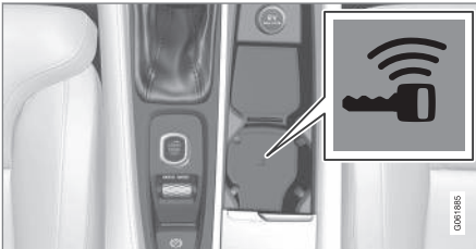
Varmistusringin sijainti lukituslaitteissa.
