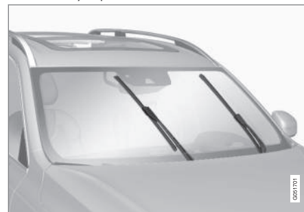
Escobillas de limpiaparabrisas en posición de servicio.
