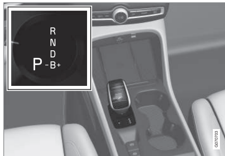
Vista general de la palanca de cambios y el patrón de cambios en la pantalla del conductor.
