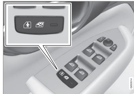
Botón de conexión y desconexión eléctrica.
