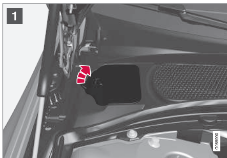
Deposito de expansión del sistema de refrigeración
