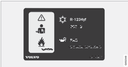
2 使用 R1234yf 冷媒車輛的空調系統資訊。
