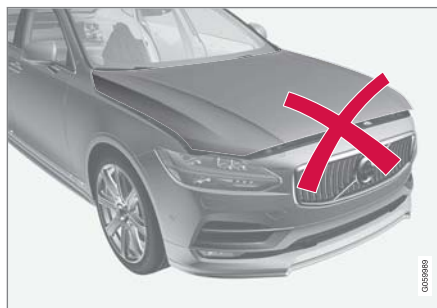
引擎蓋並未完全關閉。
