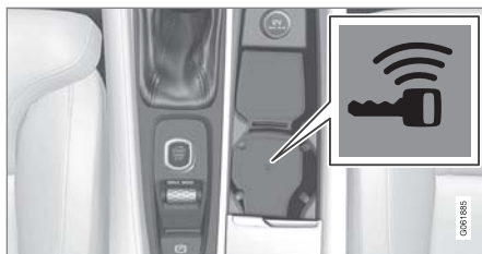
備用讀取器位於中央扶手控制台中。
