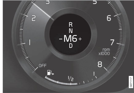
Küçük vites kolu* için 12 inç sürücü gösterge ekranındaki vites değiştirme göstergesi.
