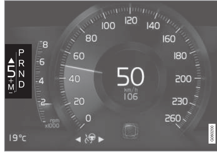
Büyük vites kolu için 8 inç sürücü gösterge ekranındaki vites değiştirme göstergesi.
