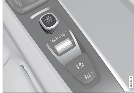
Tünel konsolundaki çalıştırma düğmesi.
