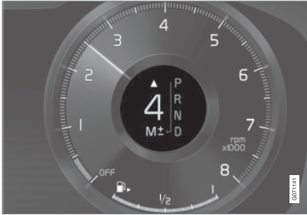
Büyük vites kolu* için 12 inç sürücü gösterge ekranındaki vites değiştirme göstergesi.
