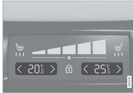
ตัวควบคุมอุณหภูมิมบนส่วนควบคุมสภาพอากาศที่ด้านหลังของคอนโซลบริเวณโพงเพลงกลาง
