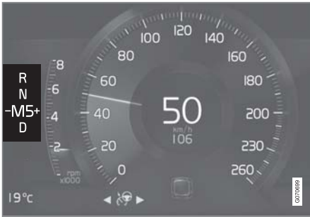
ตัวแสดงการเปลี่ยนเกียร์ในจอแสดงผลสำหรับคนขับขนาด 8 นิ้ว ในรถรุ่นที่ใช้คันเกียร์ขนาดเล็ก
