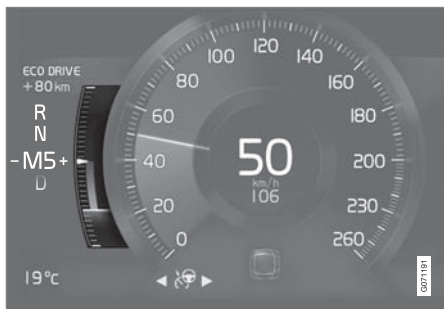
เกจวัด Eco บนจอแสดงผลสำหรับคนขับขนาด 8 นิ้ว
