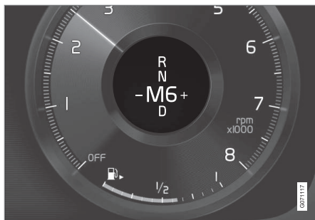
Индикатор переключения передач на 12-дюймовом дисплее водителя для компактного рычага переключения передач*.
