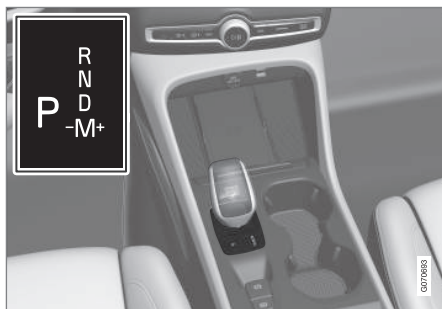
Вид компактного рычага переключения передач и схема переключения передач на дисплее водителя.
