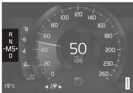
Индикатор переключения передач на 8-дюймовом дисплее водителя для компактного рычага переключения передач.
