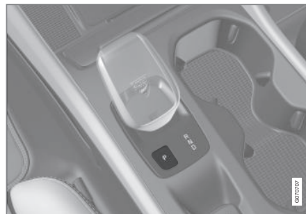
Схема высокого рычага переключения передач и положения передач.
