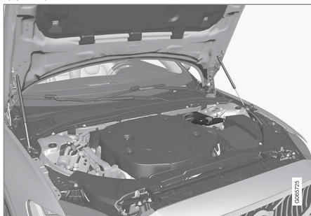
Вспомогательный аккумулятор 12 В установлен в моторном отсеке.
