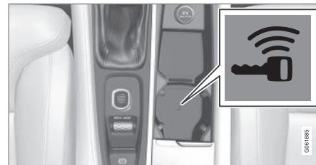
Расположение резервного считывающего устройства в тоннельной консоли.
