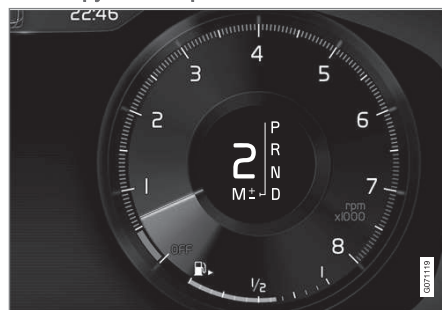
Изображение схемы переключения передач на дисплее водителя для высокого рычага переключения передач.
