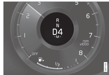
Дисплей водителя при переключении передач с помощью лепестков для компактного рычага переключения передач.
