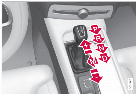
Схема высокого рычага переключения передач и положения передач.
