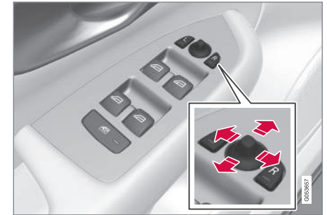
Comando dos retrovisores exteriores.
