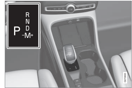
Panorâmica geral de alavanca das mudanças pequena e padrões de mudanças no mostrador do condutor.
