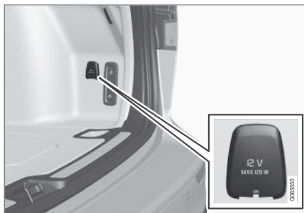
12V-aansluiting in kofferbak/bagageruimte*.
