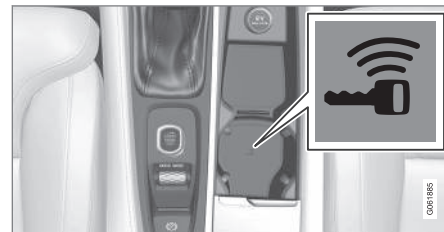
Atsarginės skaityklės vieta tunelio valdymo pulte.
