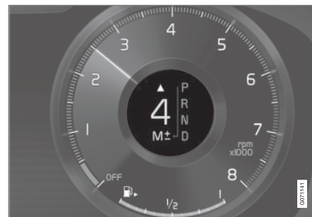
Pavarų perjungimo indikatorius 12 colių vairuotojo ekrane, automobilyje su didele pavarų svirtimi*.
