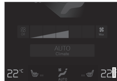
Pulsanti di temperatura nella barra del climatizzatore.
