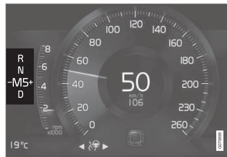
A fokozatváltás visszajelzése 8-hüvelykes járművezetői kijelzőn, kis sebességváltó karral.
