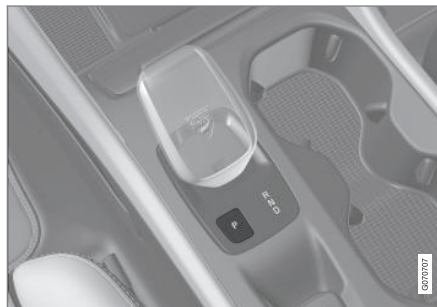
A fokozatválasztó kar és a P állás áttekintése kis sebességváltó kar esetén.
