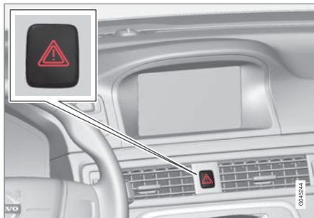
非常点滅灯ボタン
