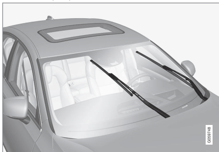
Escobillas de limpiaparabrisas en posición de servicio.
