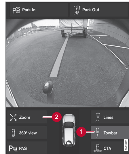
Enganche de remolque con línea auxiliar.
