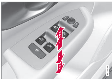
Accionamiento de los elevalunas eléctricos.
