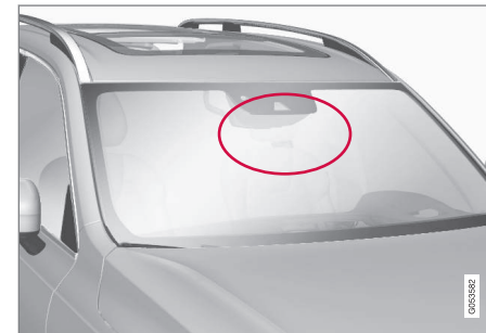
Ubicación de la unidad de radar.
