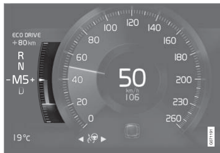
Indicador Eco en la pantalla de 8 pulgadas.
