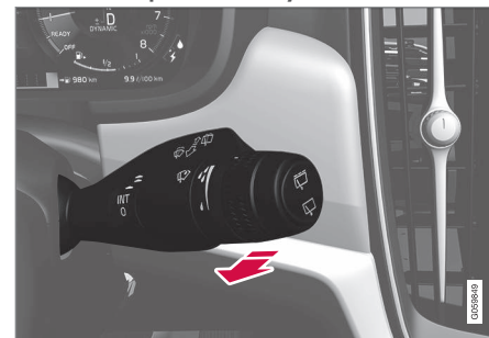
Función de lavado, palanca derecha del volante.
