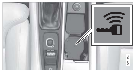
備用讀取器位於中央扶手控制台中。
