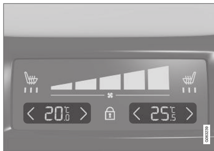
Tunnelkonsooli tagaosa kliimapaneeil olev temperatuuri regulaator.
