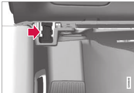
Andmeühenduse konektor (On-board Diagnostic, OBDII) asub juhipoolsel küljel armatuurlaua all.
