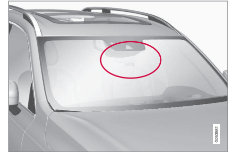
Emplacement du capteur radar.
