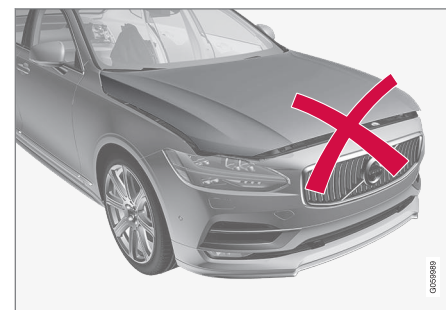
Cofano non completamente chiuso.
