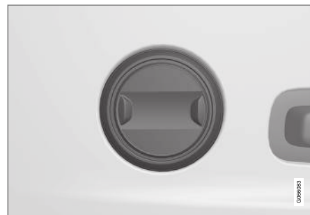
O comando em automóvel com apoio lombar de duas vias*.
