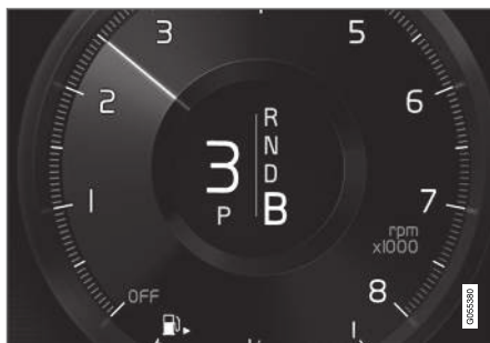
Posição B no mostrador do condutor.
