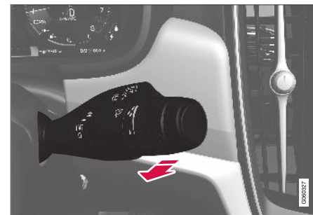
Função de lavagem, alavanca do volante do lado direito.
