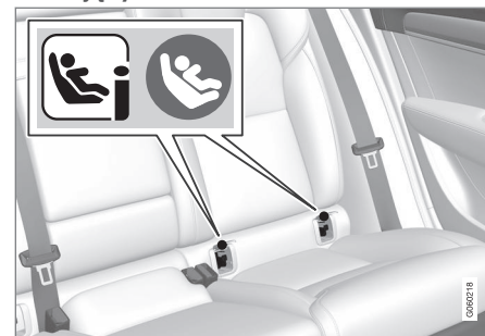
Umiejscowienie zaczepów mocujących jest wskazane symbolami 2 na tapicerce oparcia.
