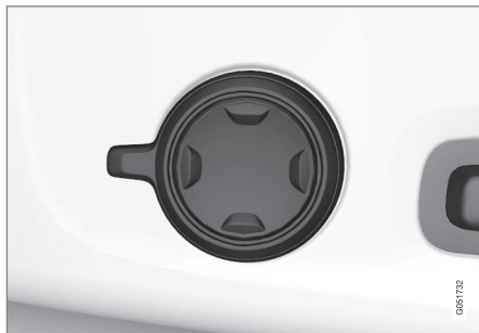
Regulator wielofunkcyjny w samochodach z czterokierunkową regulacją podparcia lędźwiowego*.
