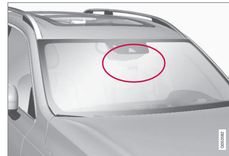
Umiejscowienie modułu radarowego.
