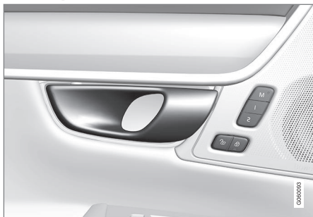
Klamka do alternatywnego odblokowania w drzwiach bocznych 11 .
