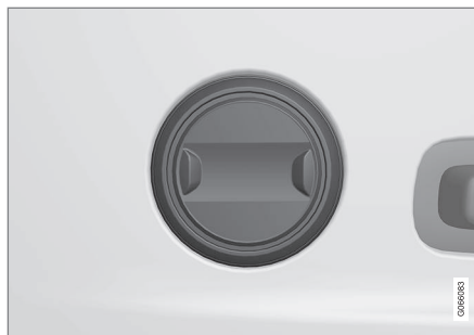
Regulator w samochodach z dwukierunkową regulacją podparcia lędźwiowego*.
