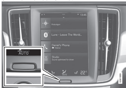
Przycisk strony głównej wyświetlacza centralnego.
