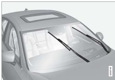
位於維修位置的雨刷片。
